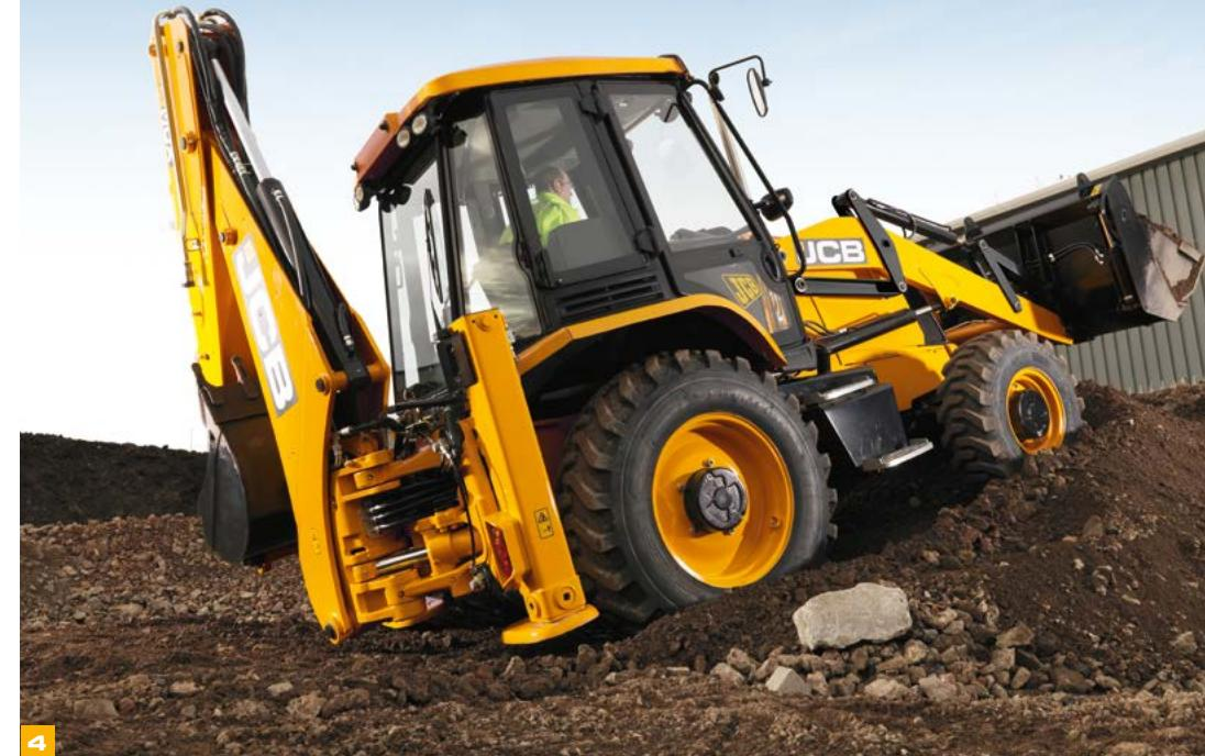
**5** Мощный механизм поворота каретки экскаваторного оборудования обеспечивает быструю и контролируемую засыпку канав.
