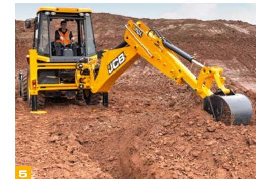
Для обеспечения максимальной производительности при любых условиях ЗСХ в стандартной комплектации оснащается полным приводом и имеет максимальную скорость движения 40 км/ч с шинами радиусом 28 дюймов.
