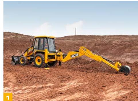
Опциональная телескопическая рукоять обеспечивает увеличение вылета стрелы и глубины копания на 1,2 м. Это уменьшает необходимость в перемещении машины и обеспечивает большую экономичность.
